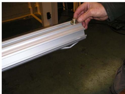
Colocación de dos tornillos en canal superior del carril
