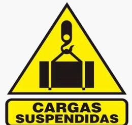
Durante la descarga con grúa se señalizarán los trabajos, y deberán respetarse las normas de Seguridad y Salud en el trabajo, evitando la presencia de personal bajo cargas suspendidas.
